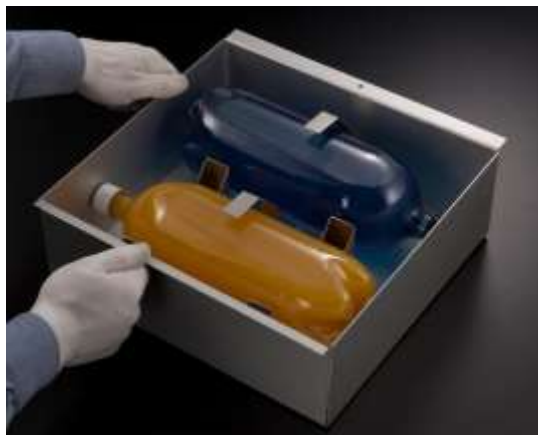
立体物ホルダーは様々なサイズが御座います。このため、飲料容器や靴、燃料タンクそしてPCハードウェアなども試験が可能です。
