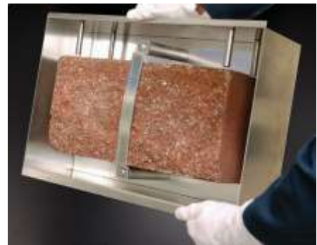
コンクリートブロックのような重量サンプルであっても、上図のような囲いを付けることで試験が可能です。このように、QUVのホルダーの汎用性は非常に高いです。
